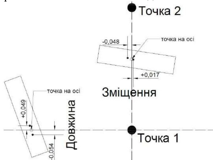
Рис. 3. Схема роботи з базовою лінією Аналогічним способом виносяться осі колон, анкерних груп і т.п.
