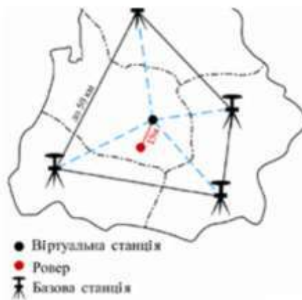
Рис. 19. Принцип віртуальної референційної станції.
