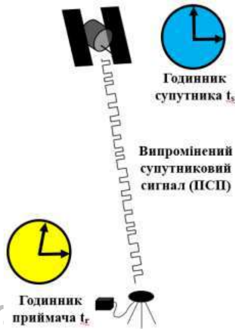
Рис. 7. Кодовий спосіб визначення псевдовіддалі.
