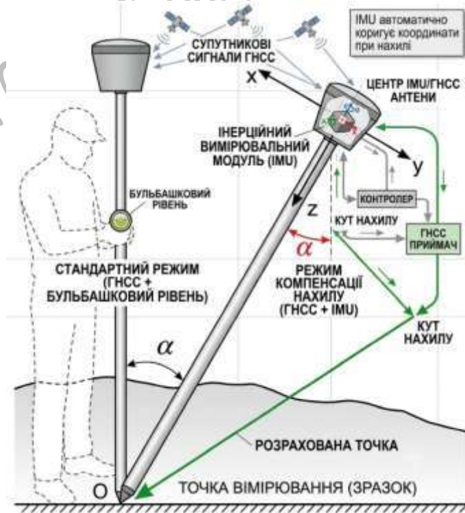
Рис. 20. Робота ГНСС-приймачем з інерціальним вимірювальним модулем.
